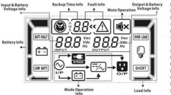
Input & Battery Voltage Info 输入和电池电压信息 Battery Info 电池信息 Backup Time Info 备份时间信息 Mode Operation Info 模式操作信息 Fault Info 故障信息 Mute Operation 静音操作 Output&Battery Voltage Info 输出和电池电压信息 Load Info 加载信息
